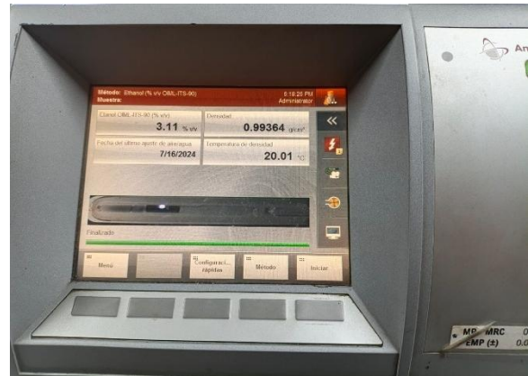
Anexo 14. Determinación del grado alcohólico (% v/v) mediante equipo digital
